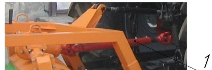
Рисунок 7. Вал карданный УМДУ-01.040.3000-70
